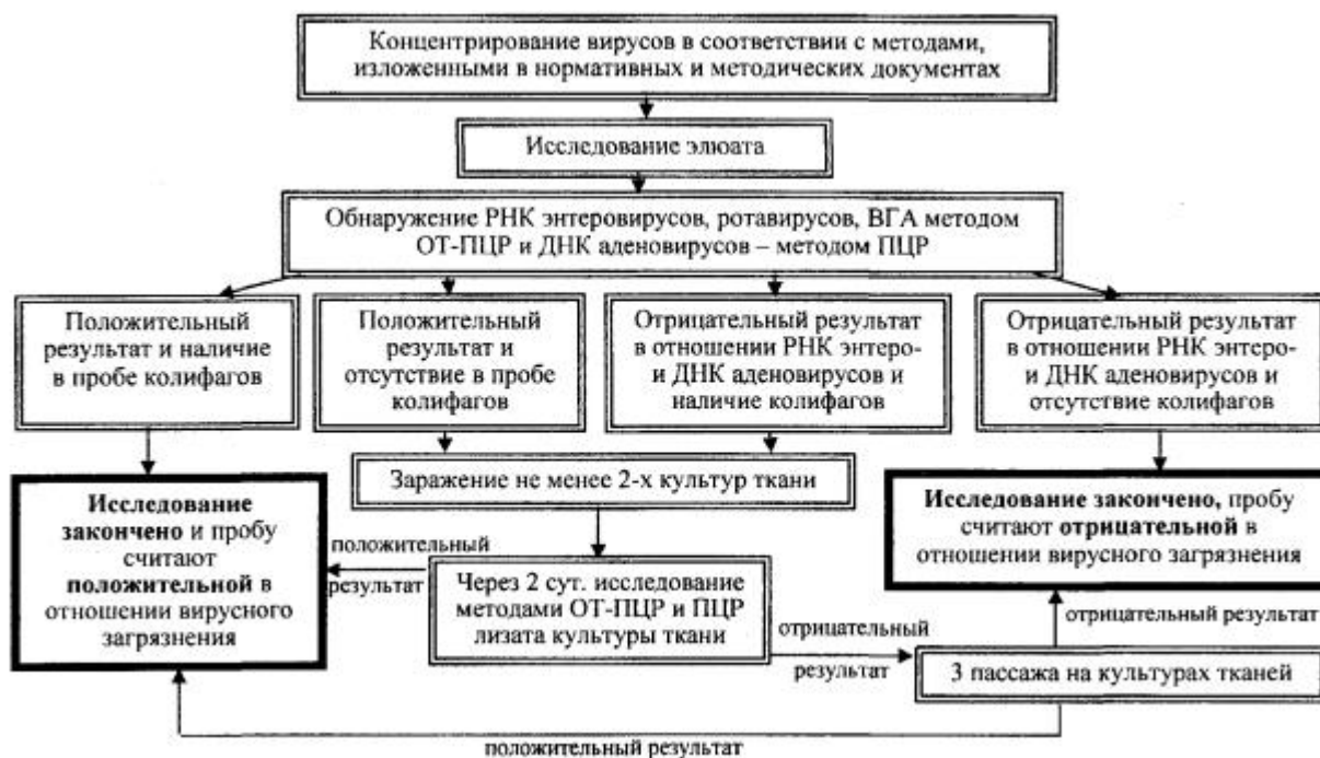
Схема вирусологического контроля воды после обеззараживания УФ-обработкой
